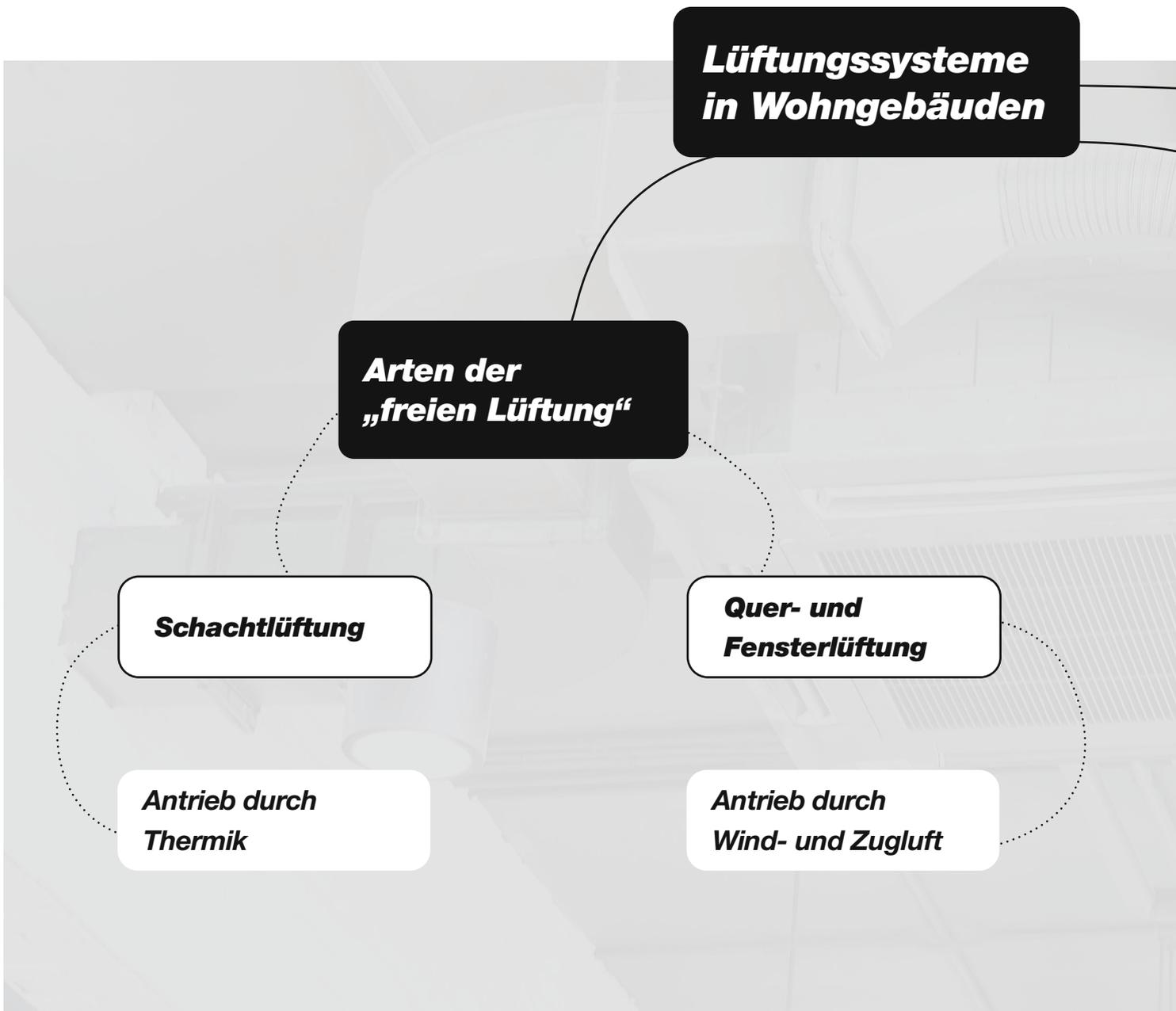
Bei den Lüftungssystemen wird zwischen der freien Lüftung, der ventilatorgestützten Lüftung nach DIN 1946 Teil 6 sowie der Entlüftung von innenliegenden Badezimmern nach DIN 18017 unterschieden. Alle Arten von Lüftungsanlagen sind für unterschiedliche Einsatzbereiche vorgesehen. Sie kommen jeweils abhängig
